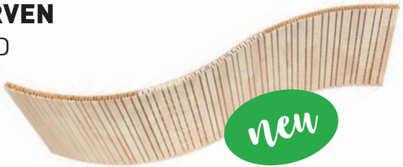
Bei Typ 3C\_33 sind die bisher starr ebenen Paneele durch modifizierten Elementaufbau in Querrichtung flexibel und können als leicht gekrümmte Flächen mit Radien ab 1 000 mm appliziert werden – konkav oder konvex gebogen auf dementsprechend gerundeter Unterkonstruktion.
